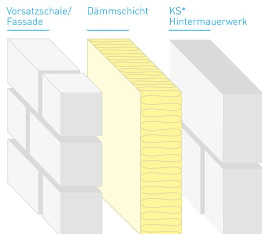
Durch eine strikte Trennung der Bauteilschichten ist es möglich, Kalksandstein sortenrein zu recyceln.
