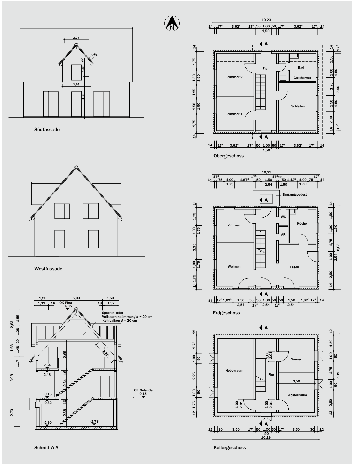
Bild 5: Beispielgebäude: Ansichten, Schnitt, Grundrisse
